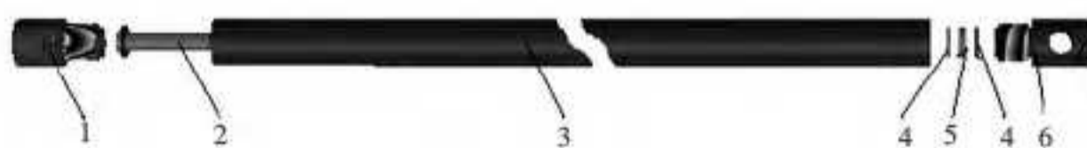
图 1 二氧化碳致裂器结构
