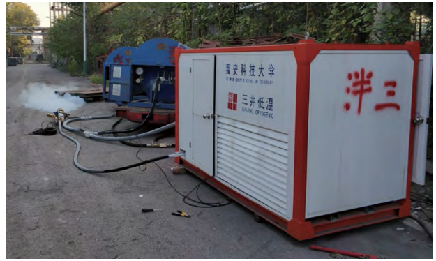
图 6 高压 (30 MPa) L-CO 2 压裂增透煤岩成套装备
