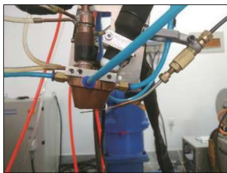
图 1 PAW-TIG 耦合电弧焊接装置示意图
