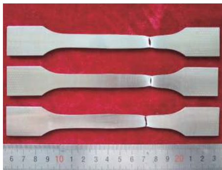
图 11 P-T 拉伸试样断裂示意图
