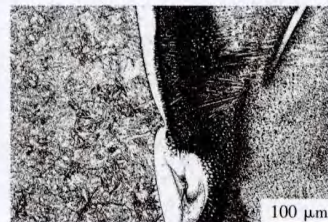
图 4 试样 S1 的热影响区微观组织
