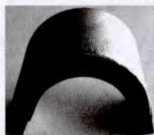
图 3 堆焊弯曲试样外观形貌
