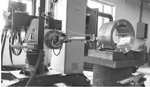
图1 试验件焊接设备组成示意
