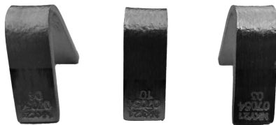
图9 晶间腐蚀试样
