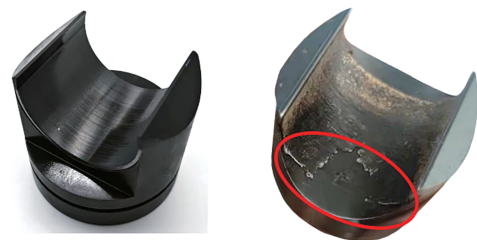
(a) 马达测试后轴瓦状态 (b) 轴瓦磨损位置
