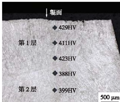
图 2 再制造热轧支承辊堆焊层显微硬度压痕形貌
