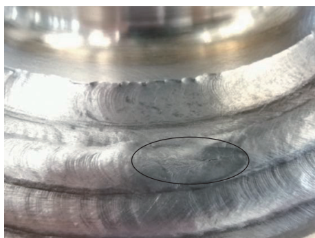
图4 典型弧坑裂纹
