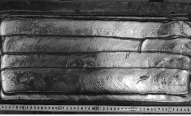
图5 试板耐蚀层堆焊后实物
