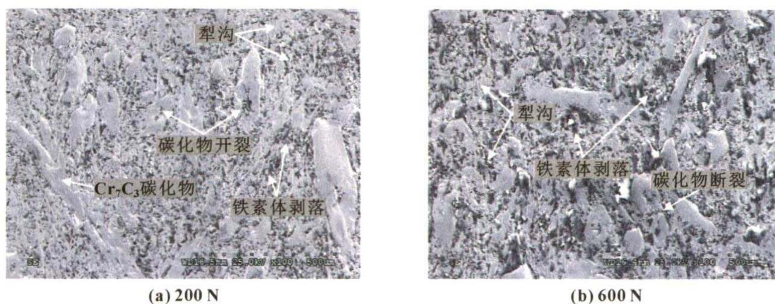
图10 高铬堆焊层的石英砂滑动磨损 SEM 形貌
