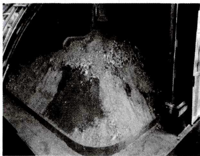
图 12 改进后的加高阳极保温料添加方式
