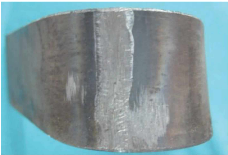
图 8 面弯试验试样
