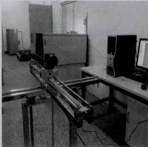
图 6 PIV 流场测试试验
