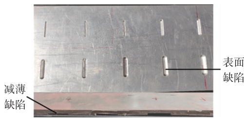
图 9 带缺陷的平板试件
