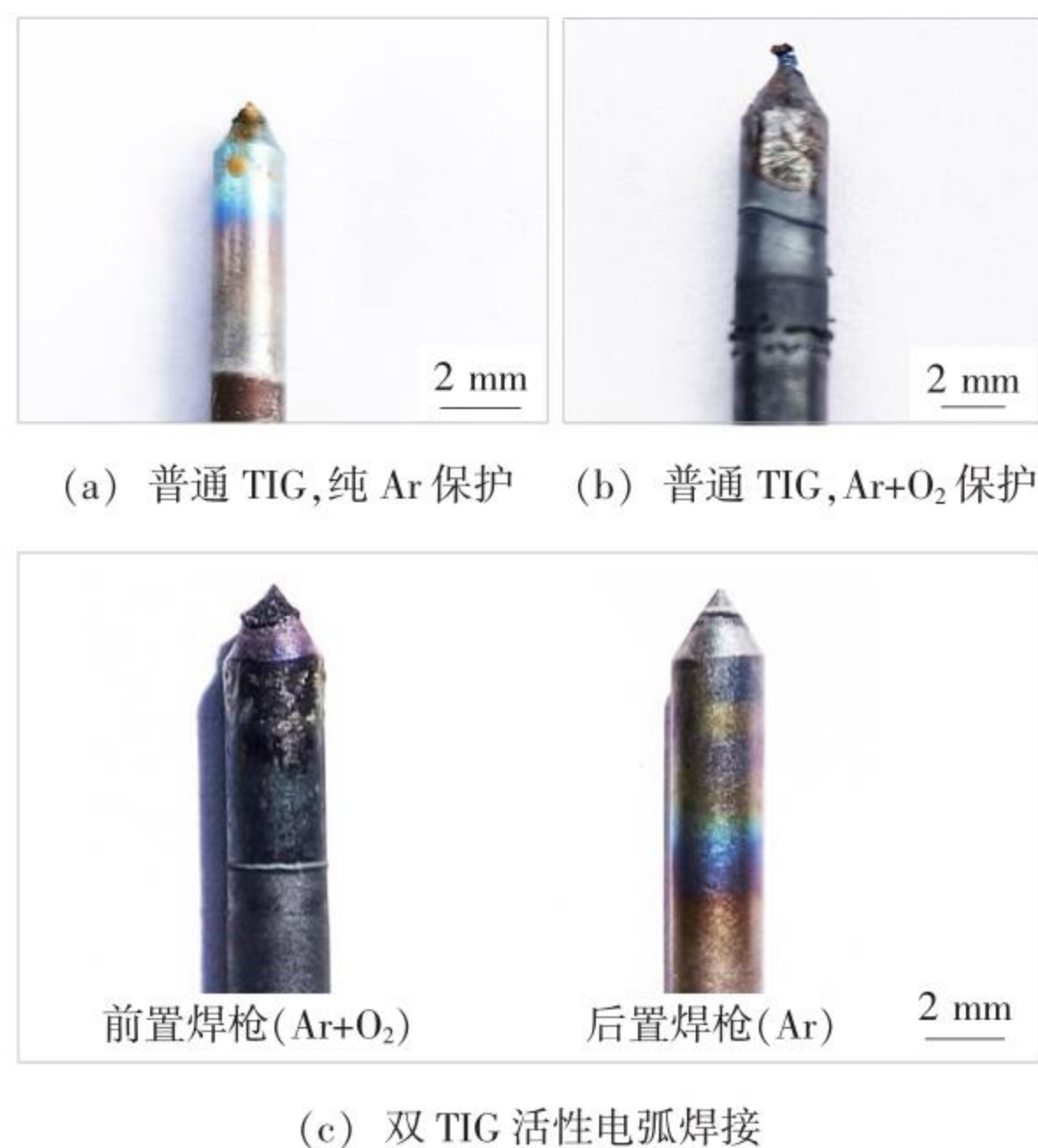
图3 钨极尖端烧损比较
