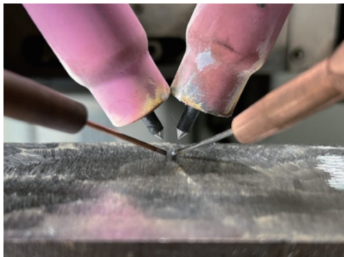
图 1 双 TIG 电弧双丝增材试验装置实物图
