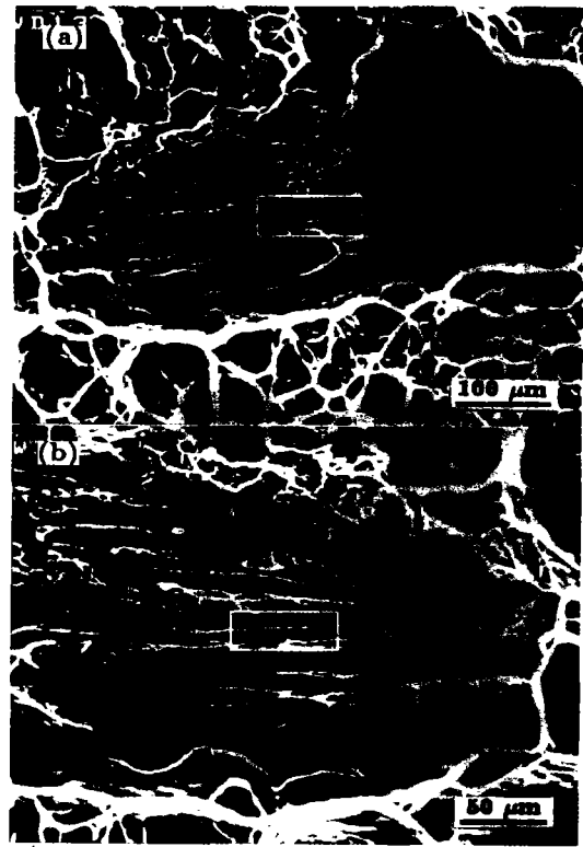
图 7 纯铝层厚 0.2 mm 层合试样同一位置断口相对两面的解理花样，方框为 EDXS 微区成分分析区域
