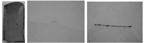
图3 6°坡口缺陷切面图(mm)
