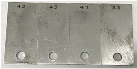
图8 试样模拟工况腐蚀实验结果
