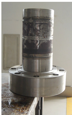
图10 整管段装置试验后形貌
