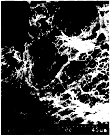
图 26 撕裂区微观形貌
