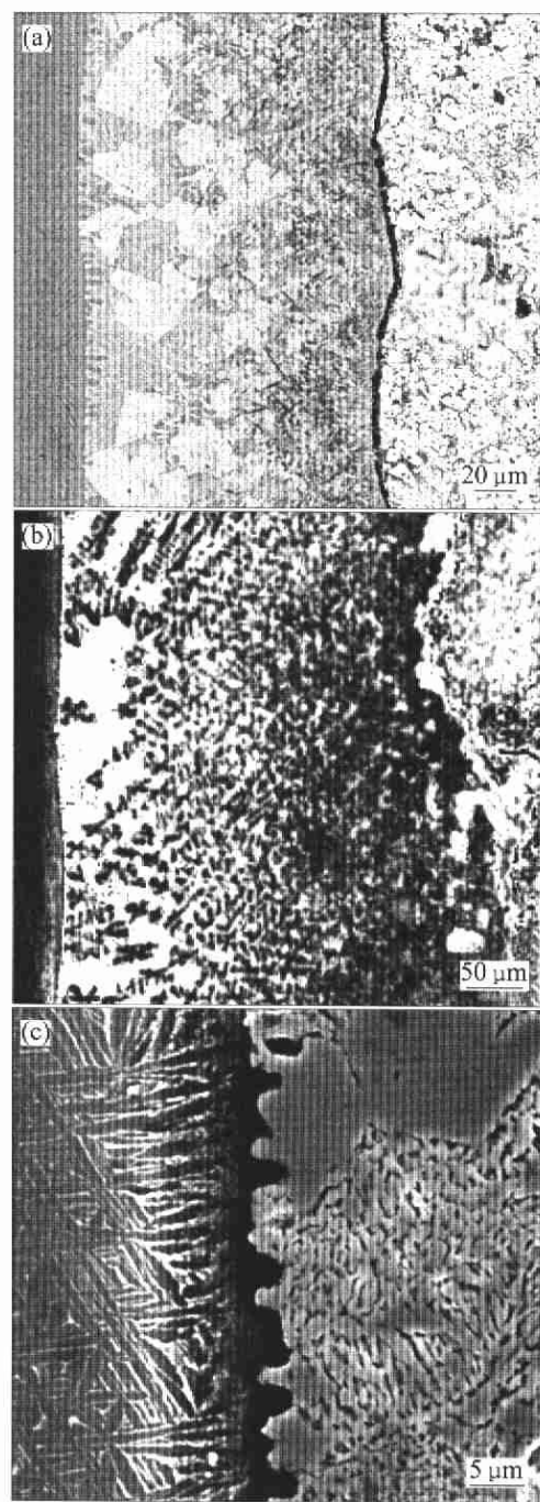
图 4 过渡层组织的 SEM 形貌
