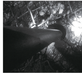
图10 液态CO 2 相变致裂孔
