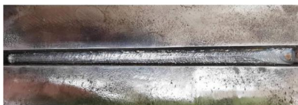
(d) 焊缝实物图
