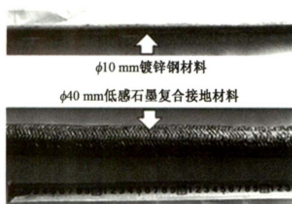
图 2 两种接地材料的结构和尺寸
