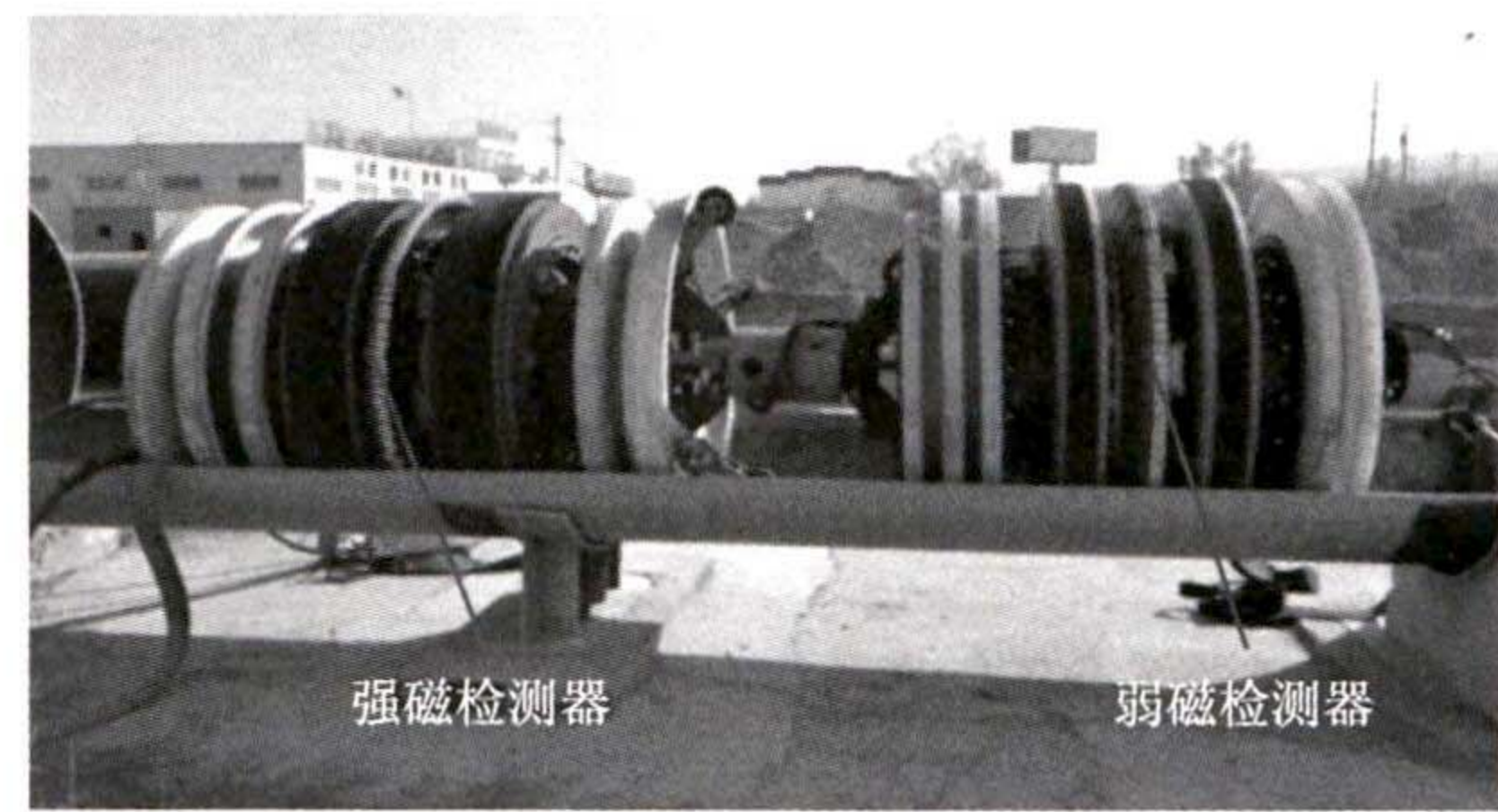
图 19 双磁场管道内检测器发球 Fig. 19 Dual magnetic field in-pipe detector serves
