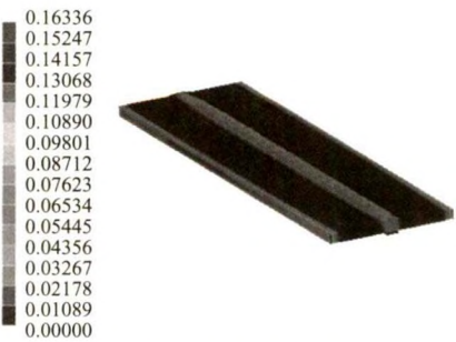
图 6 平均固有应变分布 Fig.6 Distribution of mean intrinsic strain
