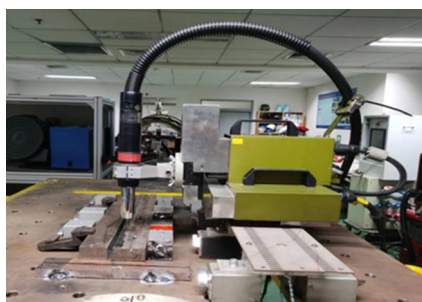
图2 基于旋转电弧的STT平焊打底试验平台
