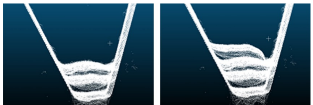
(a) 贴边焊前工件三维点云 (b) 贴边焊后工件三维点云
