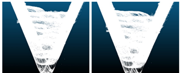
(a) 填充焊前工件三维点云 (b) 填充焊后工件三维点云
