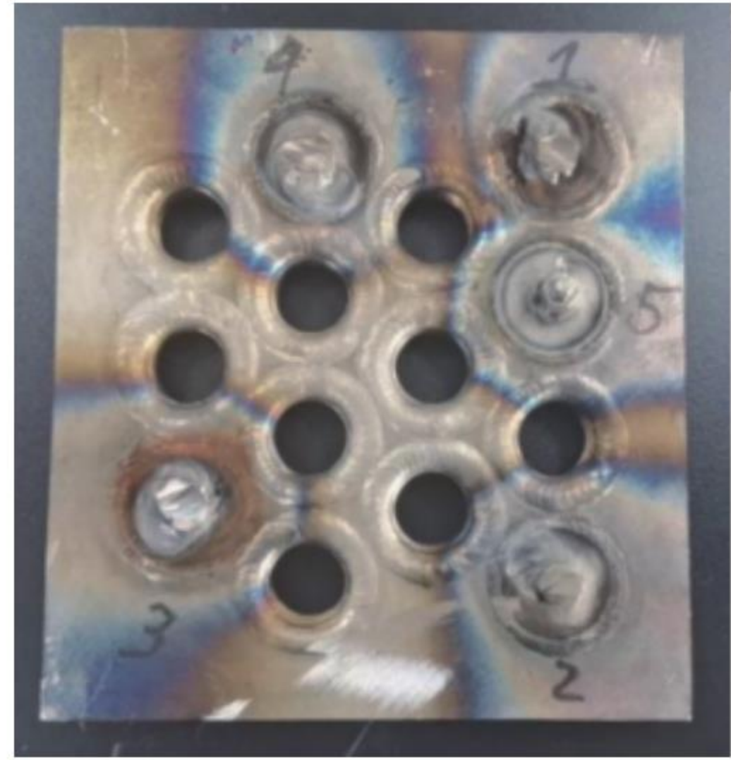
图 15 焊接传热管板材
