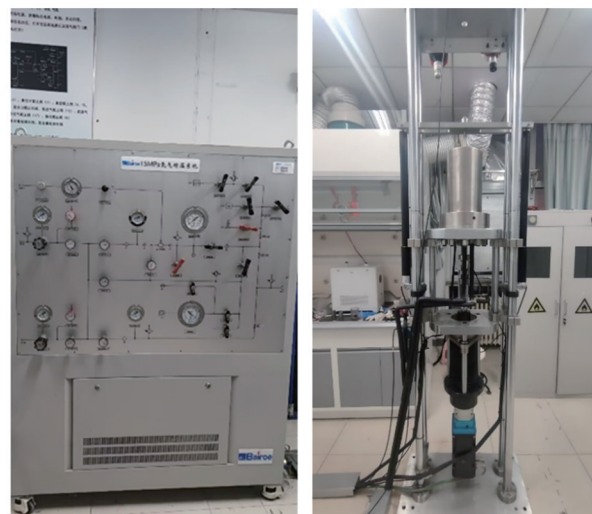
(a) 15MPa H 2 增压系统 (b) 高压气相恒应变速率拉伸试验机
