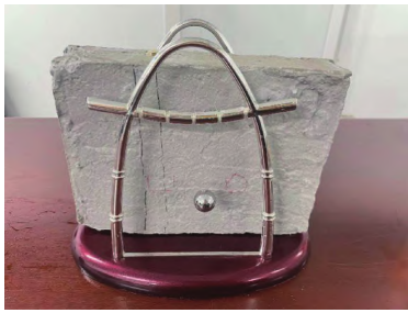
图 4 墙体内管道敲击探测实验模型图
