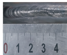
图 15 160 A 时熔池内部送丝的焊缝
