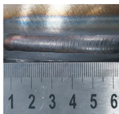
图 9 130 A 时熔池前端送丝的焊缝
