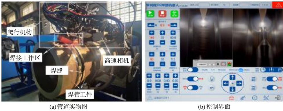
图 8 管道焊接试验平台 Fig.8 Test platform for pipe welding
