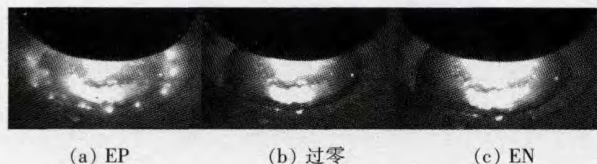
图 6 定点焊 EP 到 EN 的熔池图像
