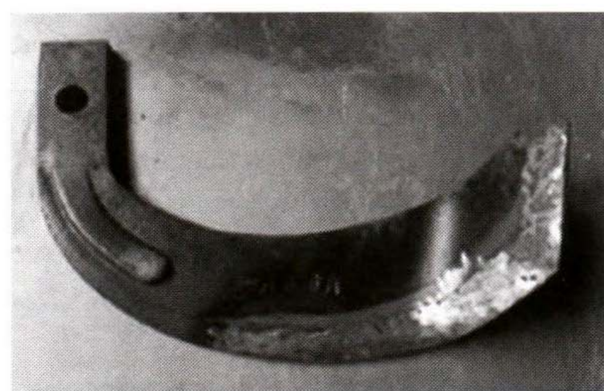
图 18 旋耕刀耐磨层堆焊
