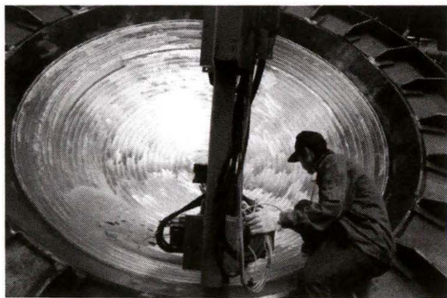
图 20 蒸汽发生器管板镍基堆焊
