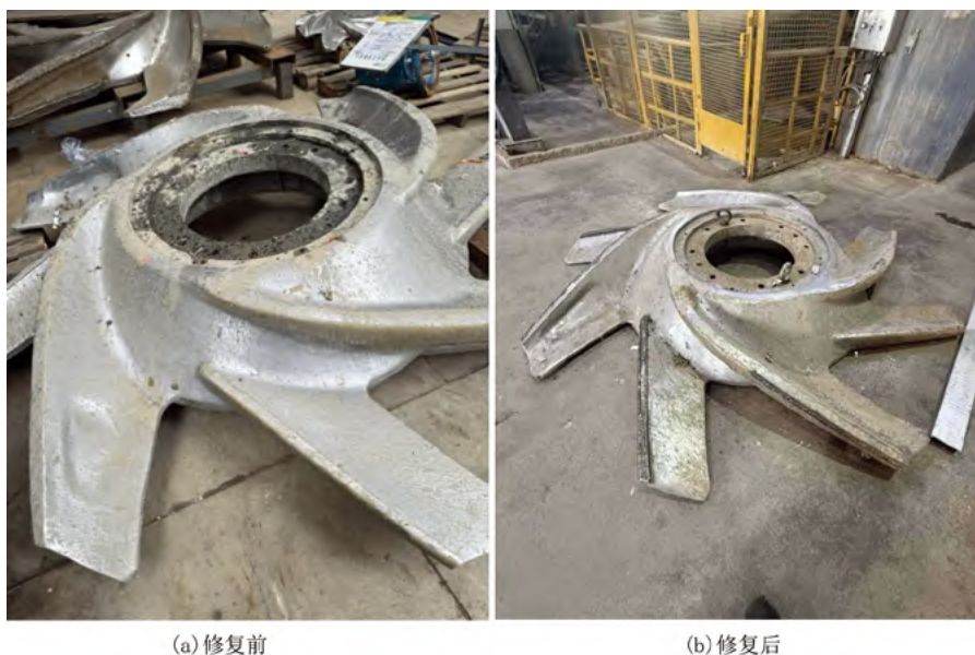
图2 堆焊熔覆修复前后的叶轮
