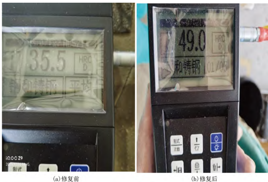
图3 堆焊熔覆修复前后叶轮硬度
