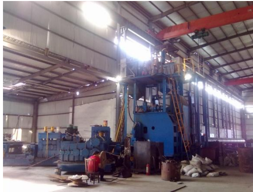
图 3 钢板螺旋环缝机械焊设备
