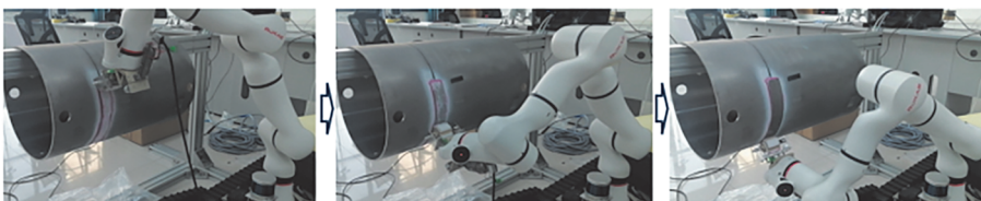
图 14 机械臂实施显像剂去除工艺
