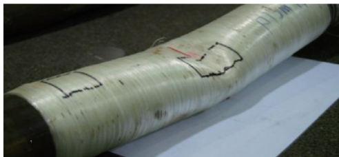
(b) 增强管道试样三点弯曲实验后的破坏图
