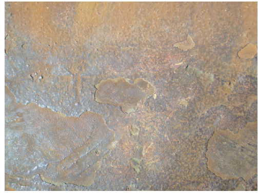
图11 均匀腐蚀宏观照片 [56]
