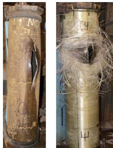
(a) 未增强管道 (b) 复合材料增强管道
