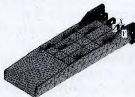
图 2 顶梁的有限元网格模型
