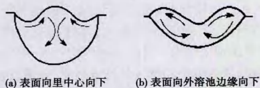
图 11 熔池流动对焊缝形貌的影响
