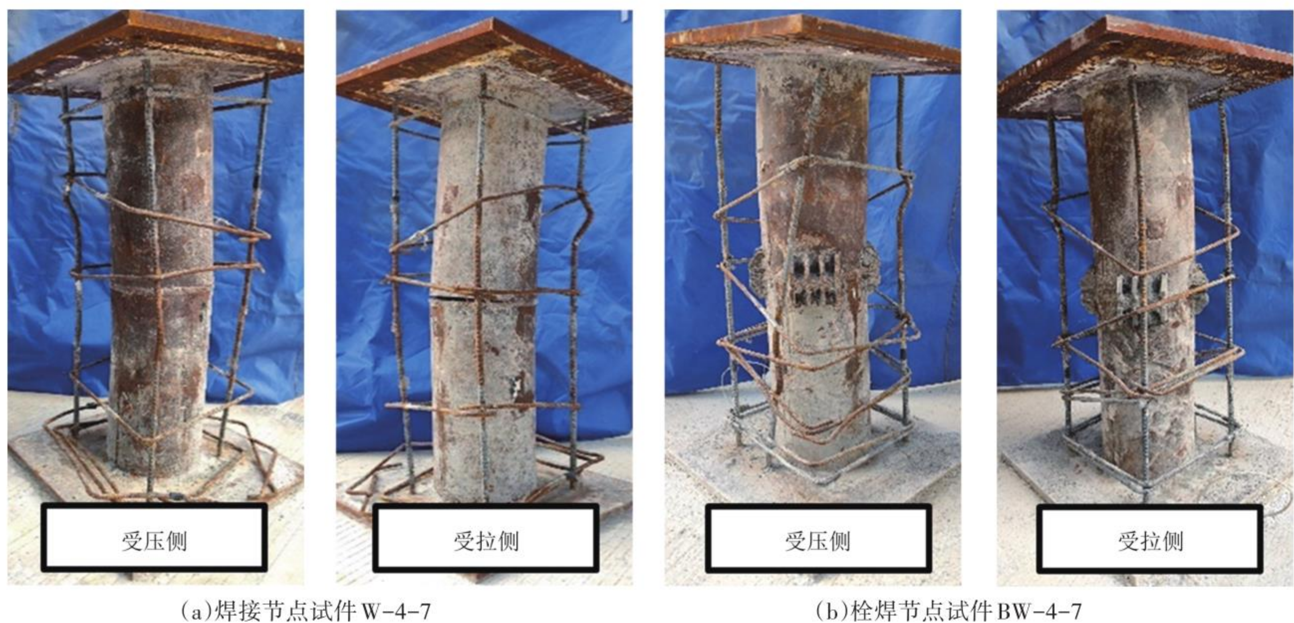
图6 内部钢管混凝土破坏模式
