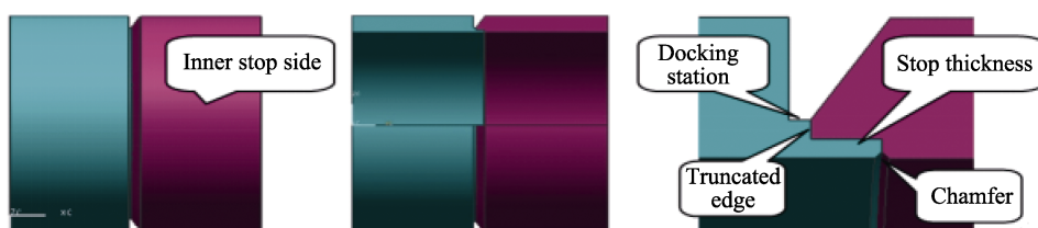
图 1 弹簧套筒管料对接单面 V 形锁底坡口形式
