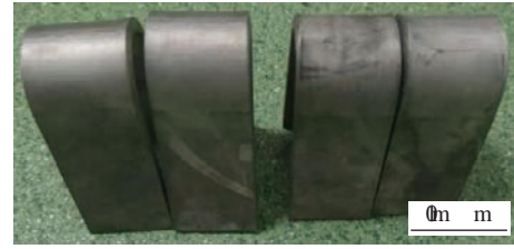
图 15 弯曲后的试样样貌
