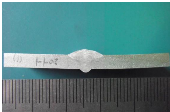
图5 焊接接头的宏观金相
