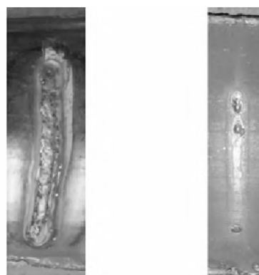
外侧焊缝成形 内侧焊缝成形 图 9 弧长调整效果
