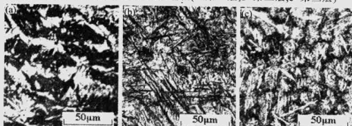
图2 试样2各堆焊层金属显微组织(a-第一层;b-第二层;c-第三层)
