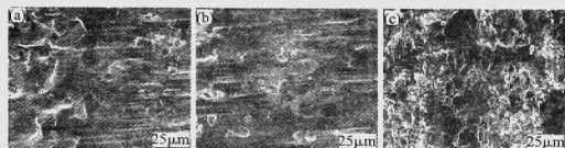
图6 微动磨损试验后磨痕心部的SEM照片(a-基材45钢;b-试样1;c-试样2)
