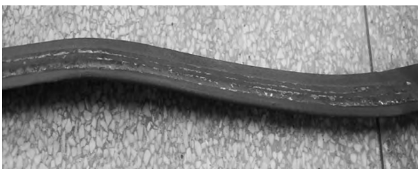
(d) 曲面堆焊焊道自动排布效果
