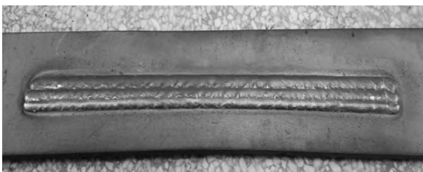
(c) 平直堆焊焊道自动排布效果
