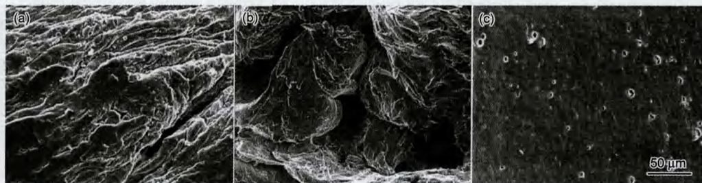
图 3 焊接接头的疲劳断口形貌
