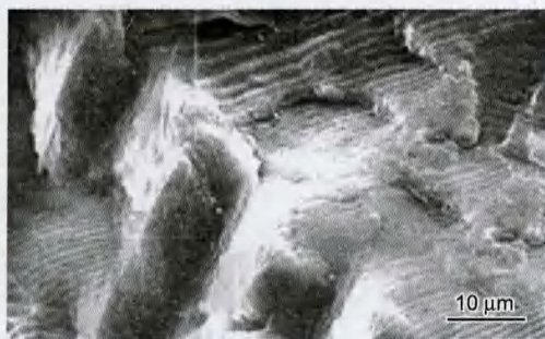
图 4 搅拌摩擦焊接接头的疲劳辉纹
